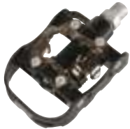
Side A: EPS-M (Compatible with Shimano SPD).
